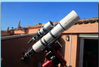
Telescopio refractor TEC140 de 140mm de diámetro y 980mm de distancia focal
