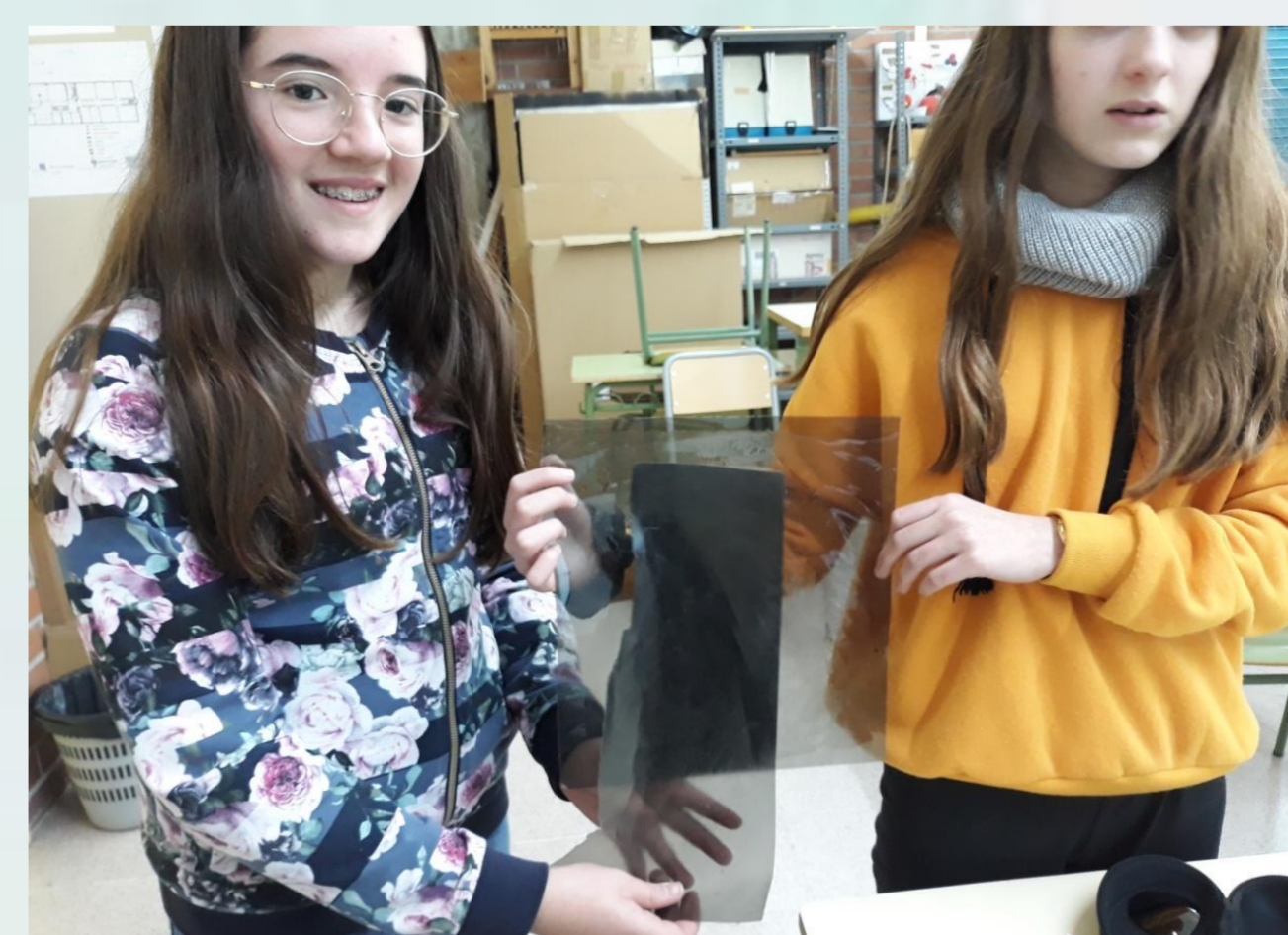
Làmines de polaritzador d'una pantalla plana d'ordinador.
