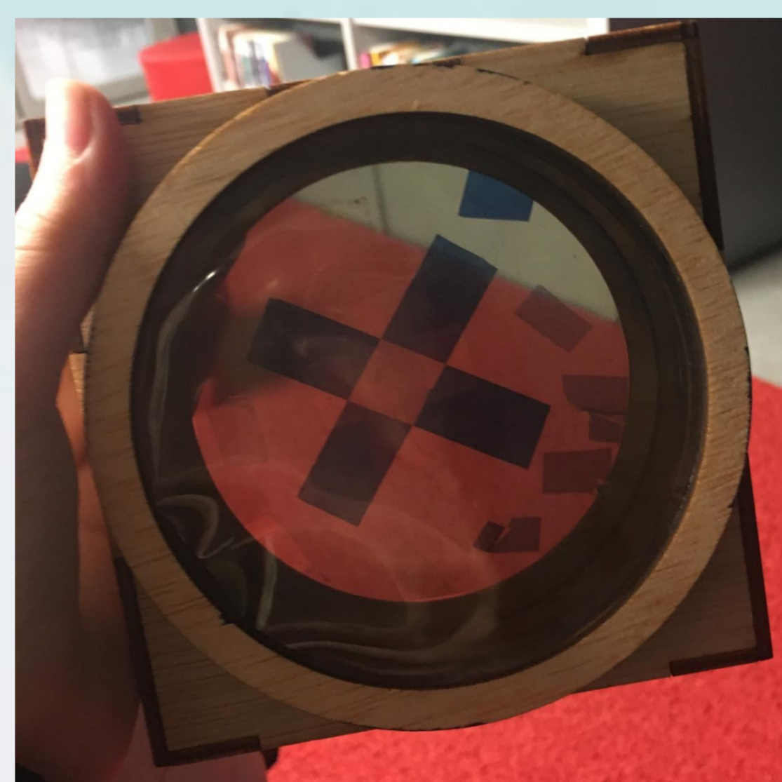
3. Observació amb polaritzadors de dues capes de cel·lo perpendiculars.
